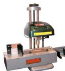
Установка для автоматического маркирования табличек ударно-точечным методом
