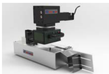
Установка для автоматического маркирования табличек лазером
